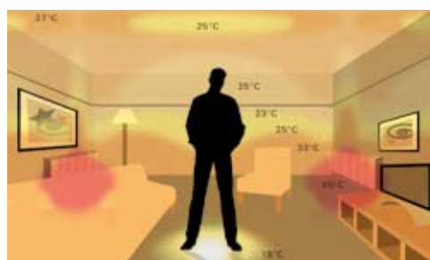
Fűtés sugárzással hagyományos fűtőrendszerhez tartozó fűtőttestekkel. Eredmény: nagy hőmérsékletkülönbség (18°C és 65°C között) a helyiségekben.
